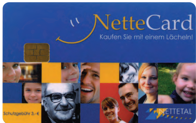
Bonuskarte mit Chipmodul, produziert im Offsetdruck
