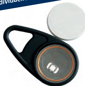
Geöffneter RFID-Schlüsselanhänger mit Blick auf den innen liegenden Transponder.
